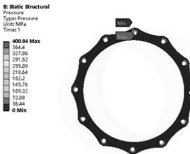
图4 安装边接触压力分布
