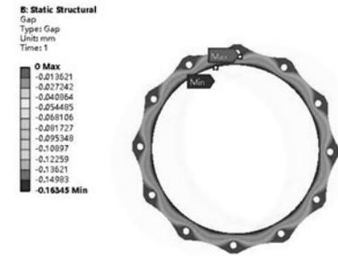
图3 安装边接触间隙分布
