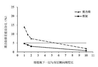
图7 不同侧向刚度比对结构位移的影响
