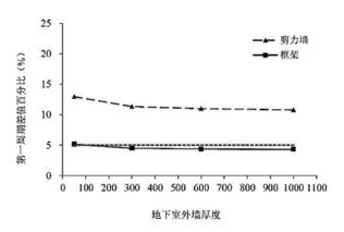
图10 地下室外墙厚度对结构第一周期的影响
