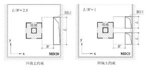
图10 考虑塔楼多个抗侧力构件附近开洞示意图
