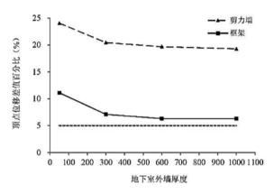
图11 地下室外墙厚度对结构顶点位移的影响
