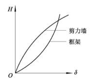
图12 框架及剪力墙结构的变形特征
