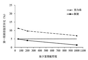
图8 地下室顶板板厚对结构第一周期的影响
