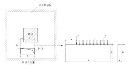
图2 柔性楼板的简化计算模型
