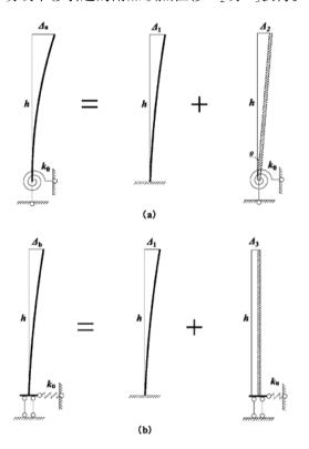
图2 水平荷载作用下顶点位移的叠加
