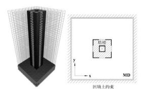
图3 剪力墙算例参照模型(MD)
