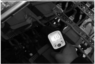
图2 1号电抗器的温度测量结果
