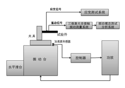
图3 电动振动试验系统工作原理
