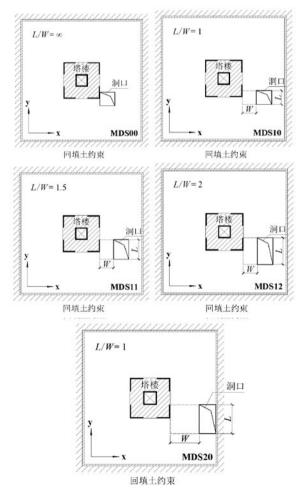
图8 考虑洞口到塔楼距离不为零时开洞示意图
