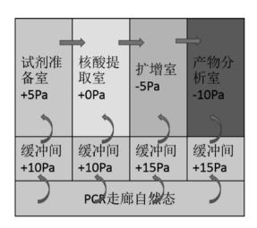
图8 PCR实验室通风设计示意图
