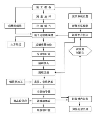
地下连续墙施工流程图
