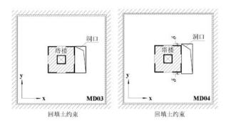
图6 考虑抗侧力构件影响范围时开洞示意图
