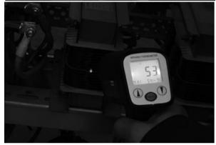
图3 4号电抗器的温度测量结果
