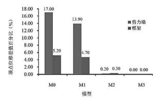
图5 不同类型约束作用结构顶点位移差值百分比
