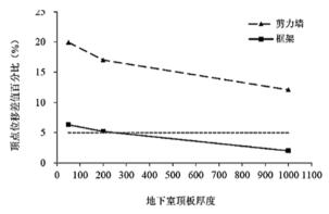
图9 地下室顶板板厚对结构第一周期的影响
