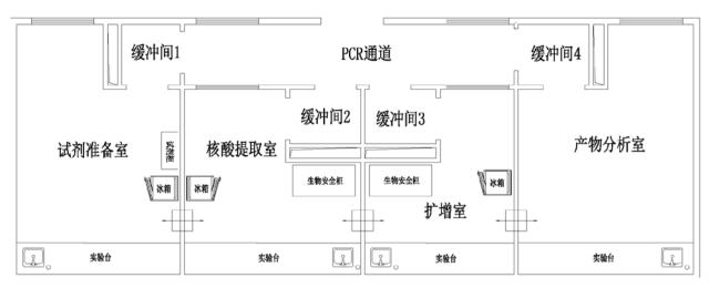
图2 PCR实验室典型工艺区划图
